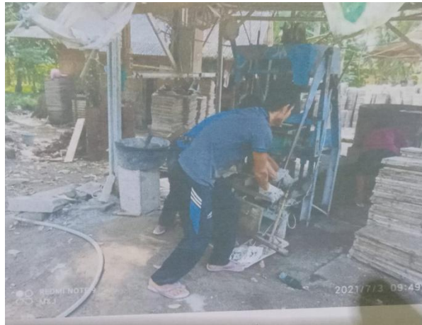
Gambar 5 : pekerja sedang melakukan pencetakan paving
