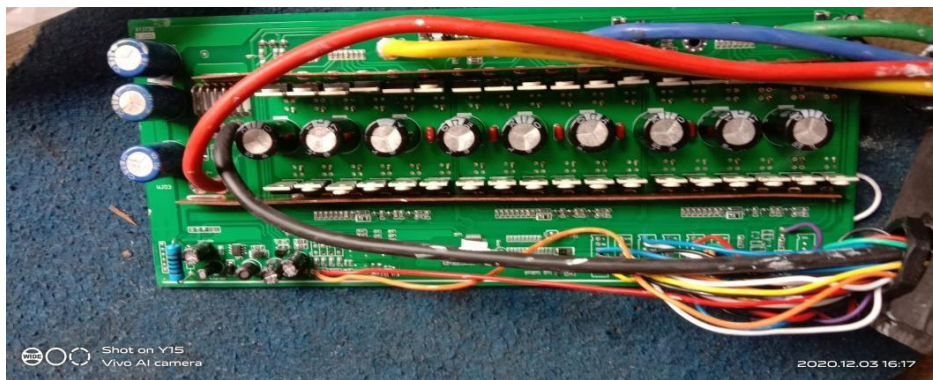
Gambar 3. 3 KONTROLLER BLDC MOTOR
