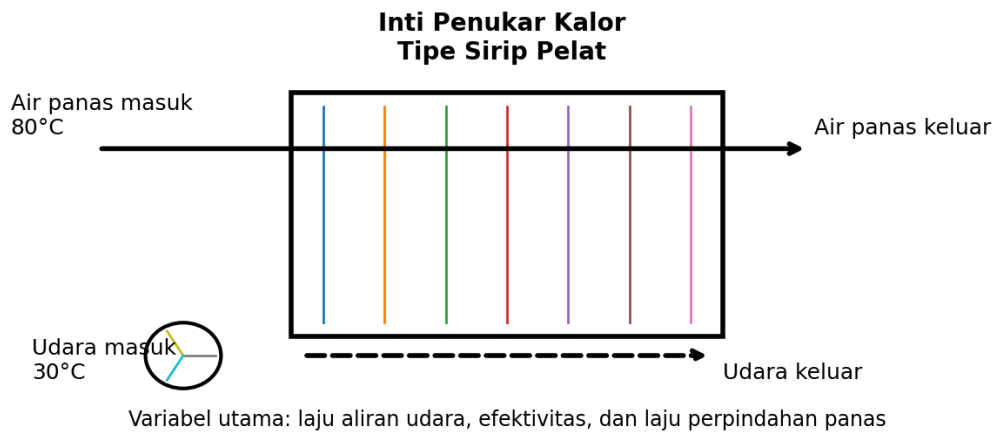
Gambar 1. Skema sederhana penukar kalor tipe sirip pelat
